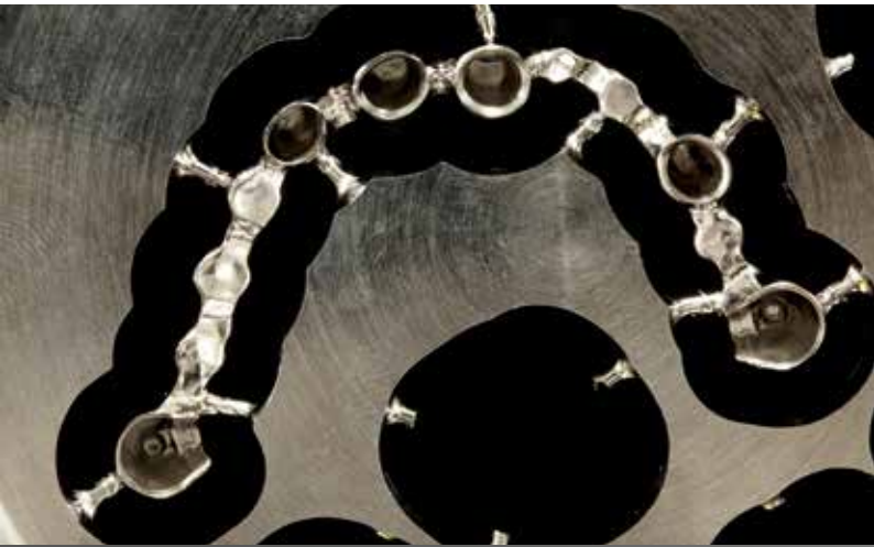
10 So erhält man zwei Strukturen, die beide digital gestützt mit der CNC-Maschine gefertigt werden können. Hier das aus einem CoCr-Blank gefräste Gerüst
